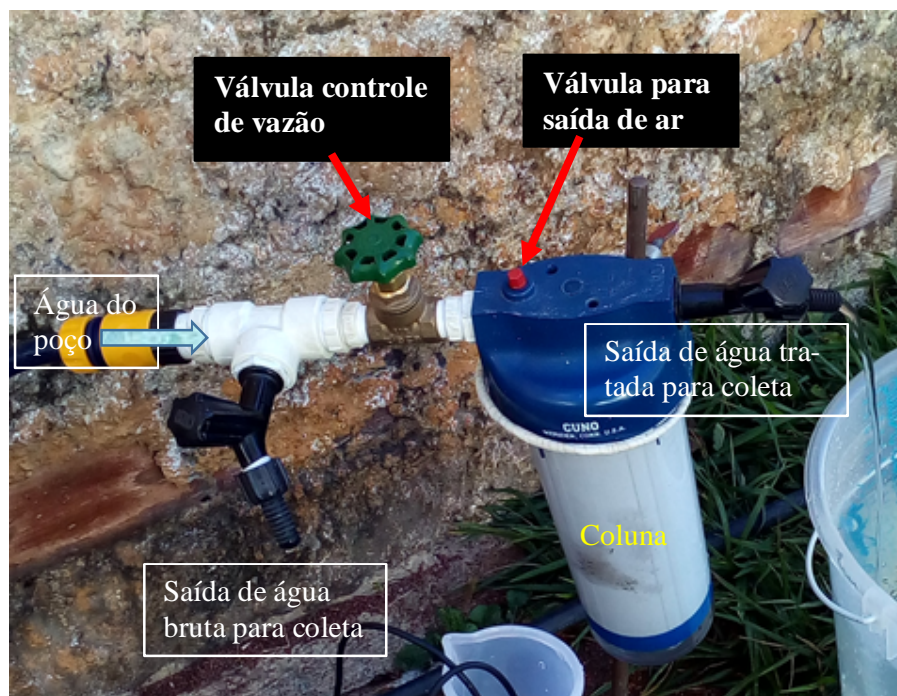
Figura 17- Sistema montado no local do poço para ensaio em coluna de leito fixo
